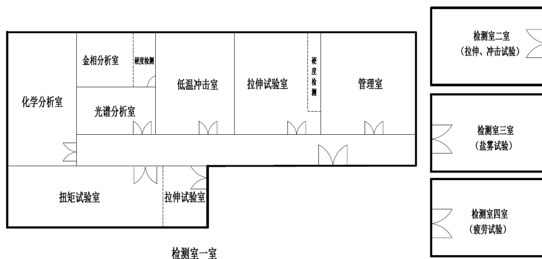
图 1 实验室平面布置图
